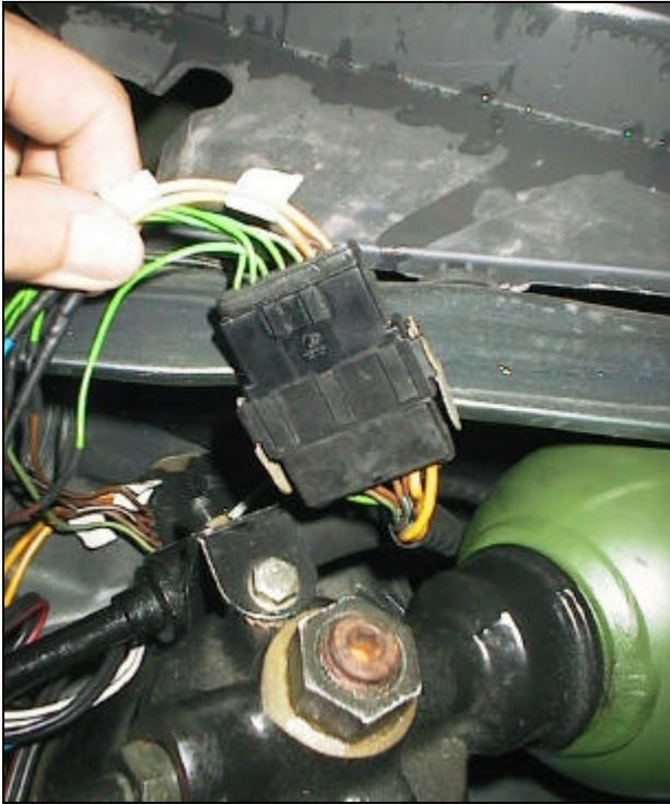
Die zwei gelben Leitungen versorgen das Magnetventil vom Hydractivcomputer aus mit Spannung. Ich habe zusätzlich zu meiner WMS parallel zu diesen zwei Kabeln eine 12 Volt LED geschaltet. So sehe ich immer genau, wann der Computer auf weich geschaltet hat. Ist viel bequemer und genauer als die Methode mit dem Radio auf Langwelle.
